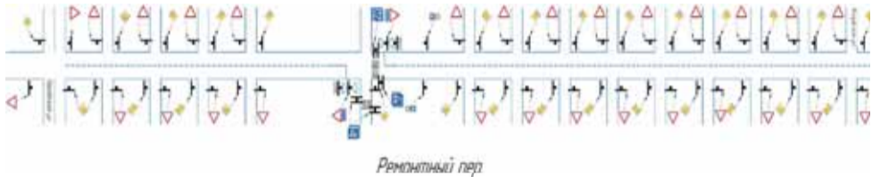
Схема нанесения горизонтальной дорожной разметки 1.5 по ул. Березовой от ул. Ручейная до ул. Восточная
