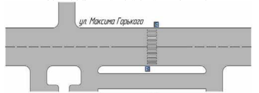
СХЕМА устройства нерегулируемого пешеходного перехода в районе дома № 100 по ул. Максима Горького
